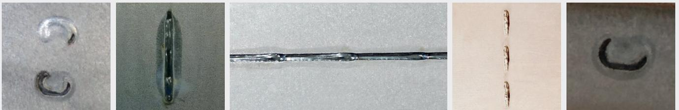
Wir prüfen mit dem Laser erzeugte Überlappnähte zwischen zwei Blechen in verschiedenen Formen und Längen.
