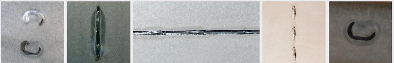
Wir prüfen mit dem Laser erzeugte Überlappnähte zwischen zwei Stahlblechen in verschiedenen Formen und Längen.
