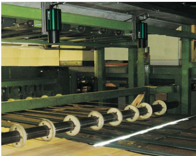
Aufnahmefeld mit Durchlicht-Linienbeleuchtung und Zeilenkameras
